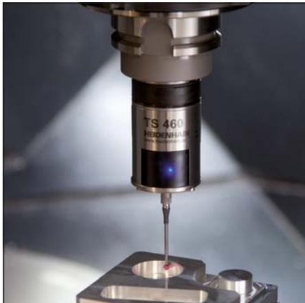
Die kabellosen Tastsysteme besitzen eine integrierte **Ablaseeinrichtung**: Über Düsen an der Unterseite des Tastsystems kann mit Hilfe von Druckluft oder eines Kühlmittelschwalls die Antaststelle von grober Verunreinigung gesäubert werden. Auch Spanablagerungen in Taschen sind kein Problem. Damit sind auch automatische Messzyklen in der mannlosen Schicht möglich. Um die Ablaseeinrichtung zu nutzen, muss die Maschine eine Druckluft- bzw. Kühlmittelzufuhr durch die Spindel ermöglichen.
